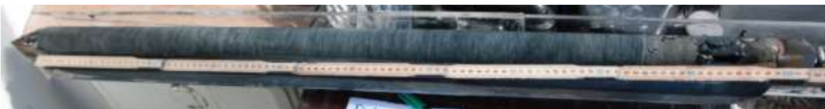
Figur 2 Rysskannborr som lagts i ett halvt sedimentprovtagningsrör och sedan öppnats och preparerats för dokumentation och provtagning.
