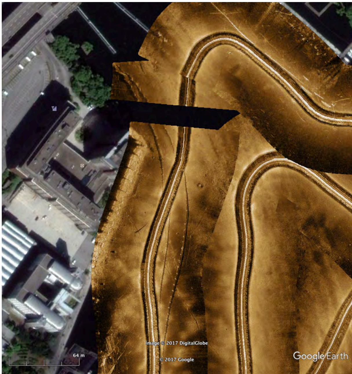
Figur 9 Uppförstoring av området strax sydost om Liljeholmsbron visande såväl fartygsspår som rörledningar.
