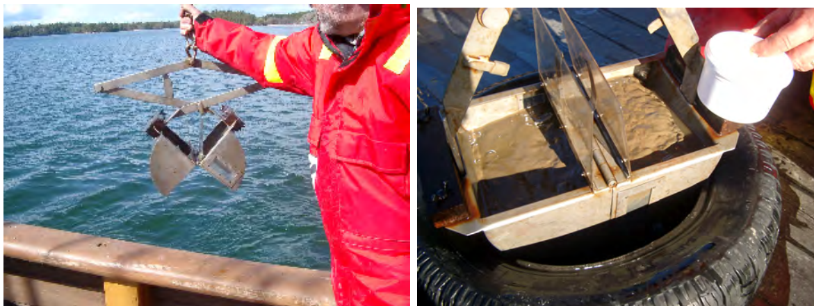
Figur 4 Vänstra bilden: Ponarhämtaren laddad och redo för hugg. Högra bilden: Ponaren öppnad och klar för ytsedimentprovtagning.
