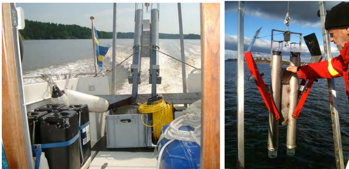
Figur 5 Vänstra bilden: Gemini-hämtare nedfälld och surrad för transport. Högra bilden: Gemini-hämtare laddad och redo för provtagning.
