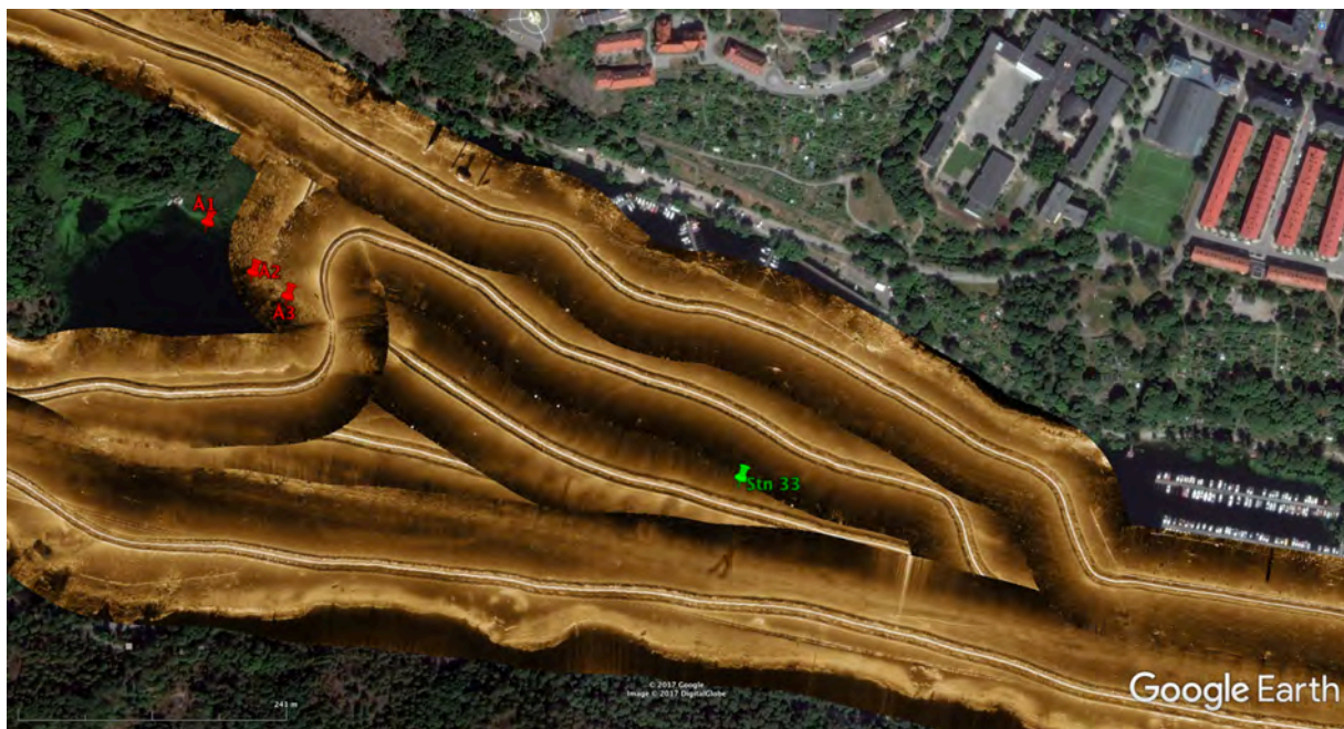
Figur 13 Sonarplott visande ackumulationsförhållanden söder om Södersjukhuset. Sedimentprovtagning längs en djuptransekt öster om Årsta holmar anges med röda tecken . Vid provtagningen 2013 (Anon. 2015) togs en sedimentkärna i detta område från Stn 33 som anges med gröna tecken .
