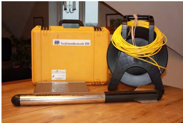
Figur 3 Portabel side scan sonar av typ DeepVision (340 KHz).
